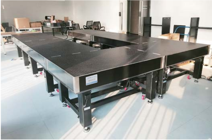
U型气浮隔振光学平台
