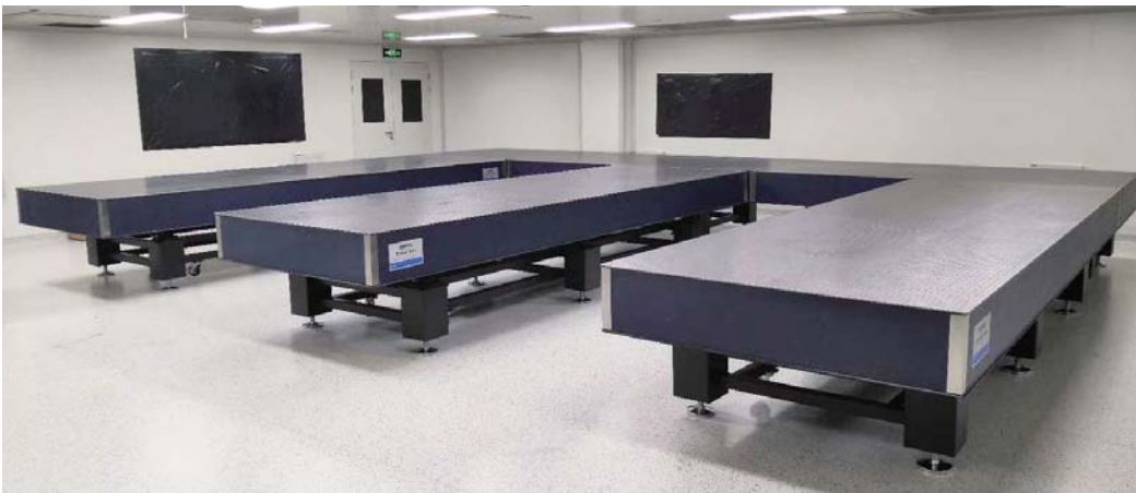
E型拼接隔振光学平台
