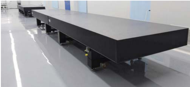
一字型拼接气浮隔振光学平台
