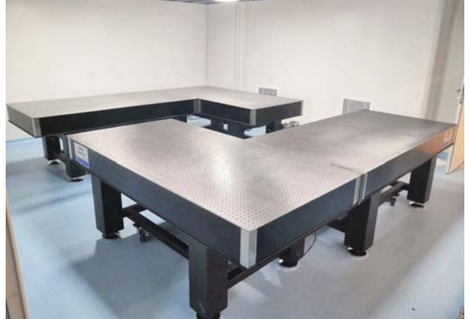
L型拼接气浮隔振光学平台
