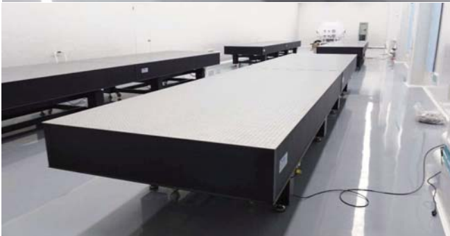
E型拼接隔振光学平台
